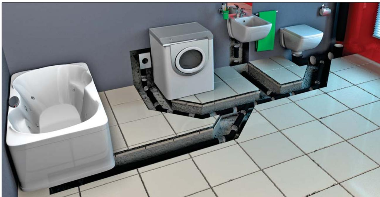
**vargokal PLUS 3S** cijevi proizvode se od polimera polipropilena (PP) s dodatkom mineralnog punila (MF) u širokoj paleti vrsta i dimenzija, a koriste za kućnu kanalizaciju i odvod vode. Ugrađuju se unutar građevinskih konstrukcija (područje primjene B) namijenjenim za stambenu i industrijsku uporabu, a posebno se koriste za odvodnju otpadnih i oborinskih voda visokih i niskih temperatura kao i za ventiliranje cjelokupnog odvodnog sustava.
