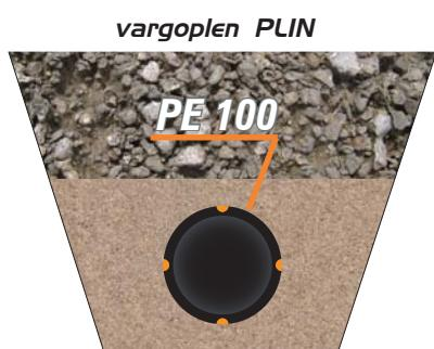
Kod ugradnje se treba pridržavati pravila o zaštiti na radu. Rov mora biti propisno dreniran, a sva mjesta spajanja treba ostaviti slobodнима dok se ne napravi ispitivanje nepropusnosti.
